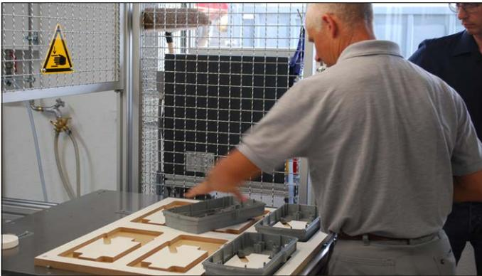
Die Bauteile werden ins Werkzeug eingelegt.
